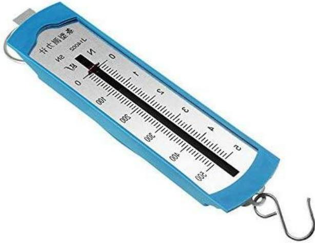
El dinamómetro es un instrumento utilizado para medir fuerzas o para calcular el peso de los objetos. El dinamómetro tradicional, inventado por Isaac Newton, basa su funcionamiento en el estiramiento de un resorte que sigue la ley de elasticidad de Hooke en el rango de medición.
