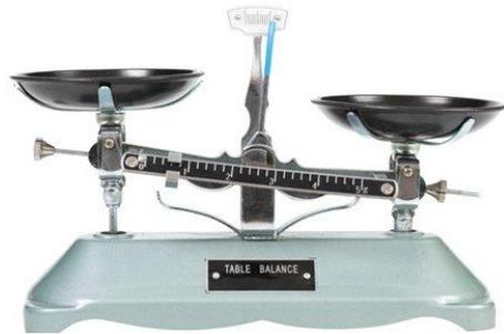
La balanza o báscula de laboratorio es un instrumento que sirve para medir la masa de los objetos. Es una palanca de primer grado de brazos iguales que, mediante el establecimiento de una situación de equilibrio entre los pesos de dos cuerpos, permite comparar masas.
